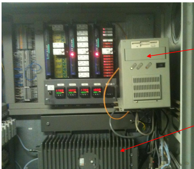
Fig. 11 Vista interna FTIR 9100 ABB
